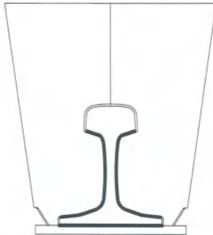
图6 砂模与相配套钢轨间隙的测量位置(图中加粗线所示)
